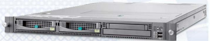
■ Die DECT Controller funktel DC100 und DC200 sind die zentrale Management-Instanz der komplexen DECT-Infrastruktur. Über den DECT Controller konfigurieren Sie über ein übersichtliches Web-Frontend alle Funktionen des DECT-Systems und behalten die angeschlossenen Endgeräte im Griff.
